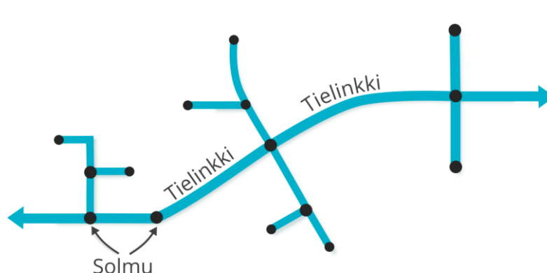
Kuva 1 Digiroadin tie- ja katuverkko muodostuu tielinkeistä
